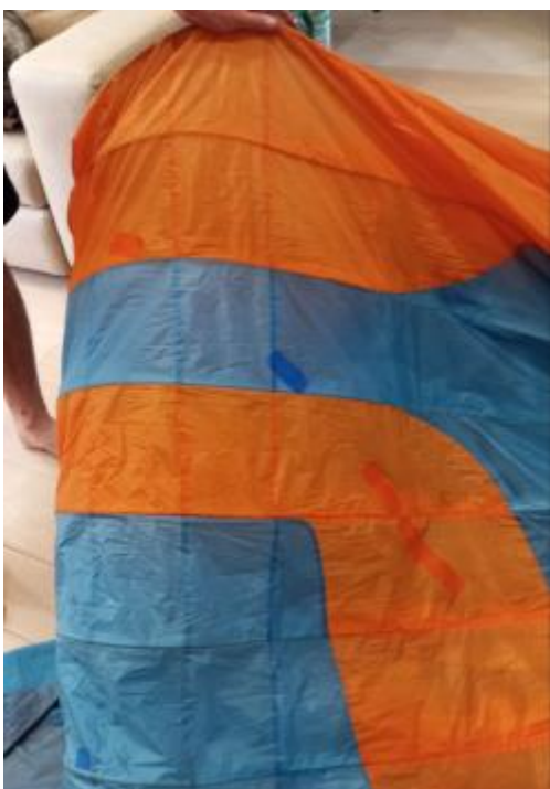
Фото 5. Порывы на крыле. Защиты рипстопом. Идет след от стропы, не разрывы о камни.
